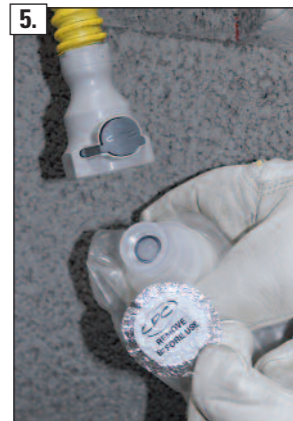
5. Die Versiegelung an der Adapterkupplung des leeren Kondensatauffangbeutels entfernen.
